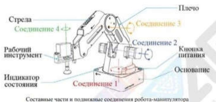
Управление роботом-манипулятором может осуществляться при помощи компьютера. Для лучшего понимания работы соединений, подключите робот-манипулятор к компьютеру при помощи USB-кабеля и запустите фирменное ПО «DobotStudio»
